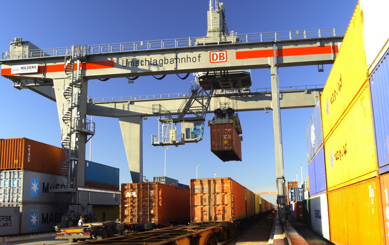
21 _ GVZ-Terminal am Güterverkehrszentrum Thüringen. Hier werden Container zwischen Bahn und Lkw umgeladen.
