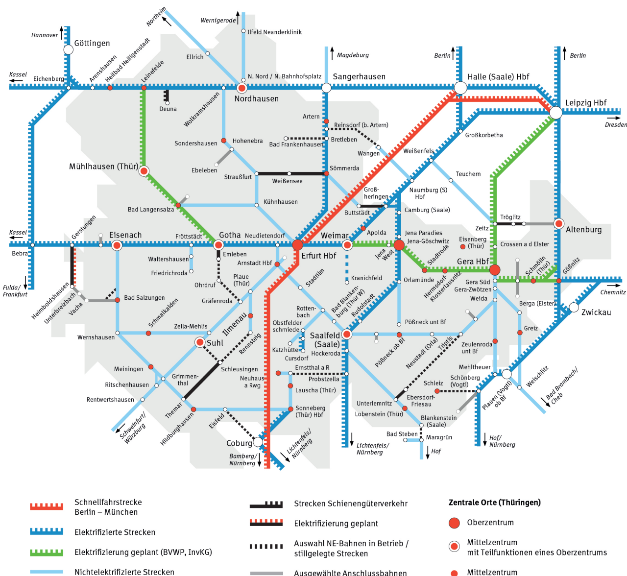
24 _ Geplante Elektrifizierungen in Thüringen, Quelle: TMIL– Masterplan. Perspektiven für die Eisenbahn-Schieneinfrastruktur in Thüringen.
